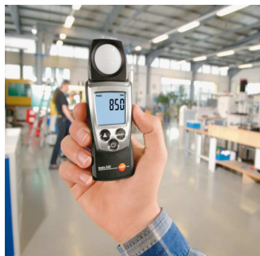
Imagen de medición de luz con un luxómetro.
